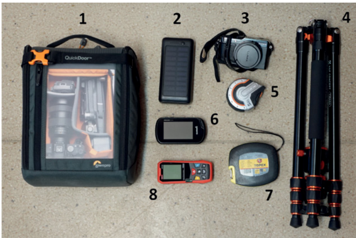
1. Futerał 2. Powerbank 3. Aparat fotograficzny 4. Statyw 5. Miarka (krótka) 6. Tracker GPS 7. Miarka (długa) 8. Dalmierz laserowy
